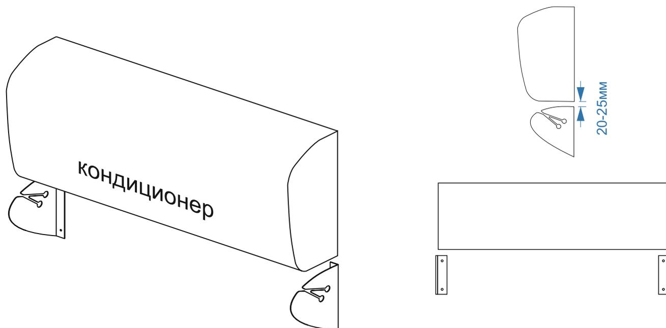
1. Установить держатели экрана под кондиционером на расстоянии 20-25мм от нижней поверхности экрана и закрепить на стене
